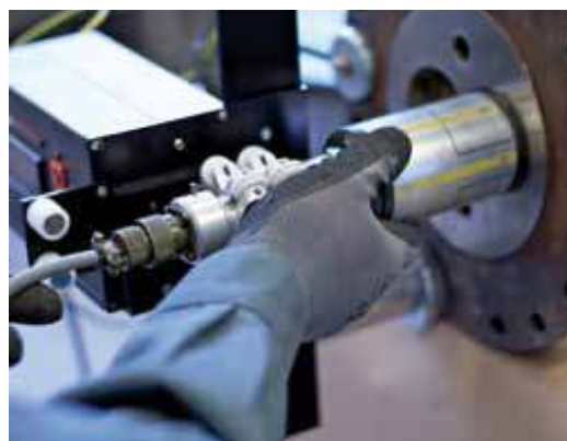
Измерение прямо на экструдерной линии. Диапазон измерений датчика: 47-133 мм в диаметре.
